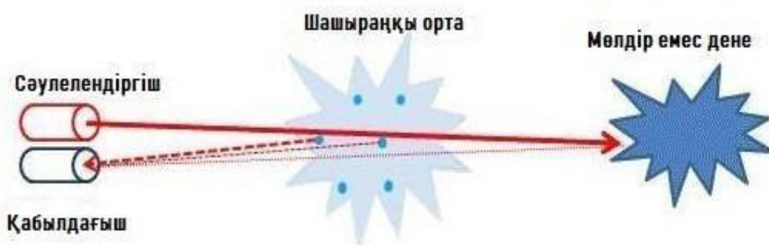
1.11 - сурет – Импульстік лазерлік дальномердің жұмыс істеу принципі
