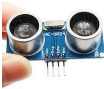
А.2 - сурет – Ультрадыбысты дальномер HC-SR04
